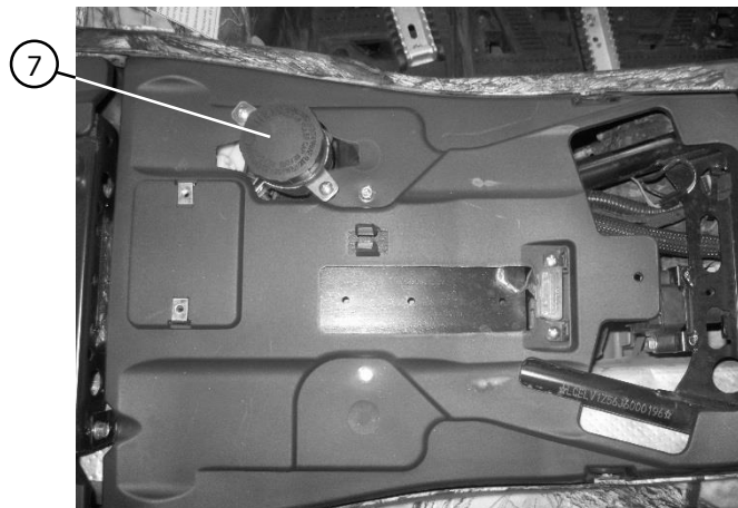
7) Расширительный бачок тормозной системы
