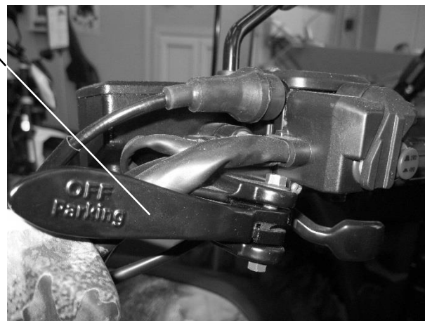
5) Рычаг стояночного тормоза (в левом положении «OFF Parking»)
