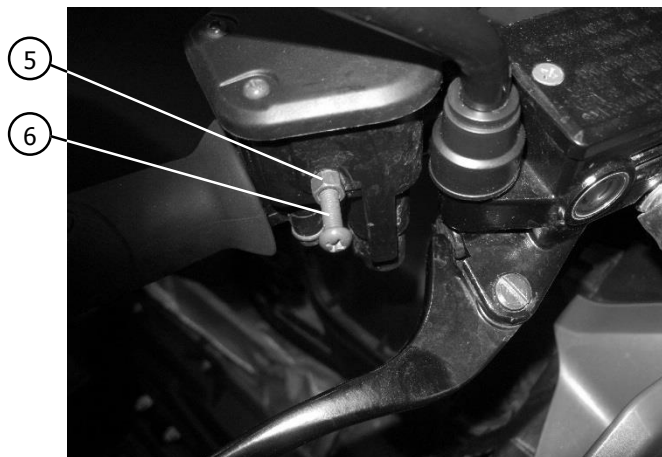
5) Контргайка винта регулировки курка газа 6) Винт регулировки хода курка газа
